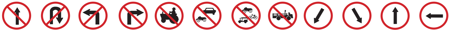
1-5 ห้ามเข้า 1-6 ห้ามกลับรถ 1-7 ห้ามเลี้ยวซ้าย 1-8 ห้ามเลี้ยวขวา 1-17 ห้ามรถ แทรกเตอร์ 1-18 ห้ามรถ จักรยานยนต์ หรือรถยนต์ 1-19 ห้ามรถจักรยาน รถสามล้อ และ รถจักรยานยนต์ 1-20 ห้ามรถ อีแต่น 1-29 ให้ชิดซ้าย 1-30 ให้ชิดขวา 1-31 ให้รถเดิน ทางเดียว 1-32 รถเดินทางเดียว ไปทางซ้าย
